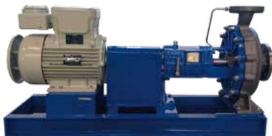
Pompe centrifughe normalizzate, sono costruite in diverse leghe metalliche, per venire incontro alle richieste del mondo chimico e petrolchimico, disponibili in versioni a tenuta meccanica o a trascinamento magnetico, in versione con giunto o monoblocco.
