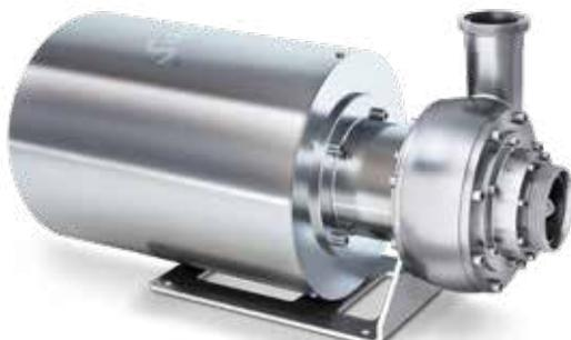
La pompa centrifuga sanitaria ibrida della serie LES, è una valida alternativa alle pompe a canale laterale, ha il corpo anteriore della pompa, appositamente sviluppato con un inducer e un sistema di ricircolo integrato, che ne consente con successo l'utilizzo come pompa autoadescante. Disponibile a tenuta meccanica o a trascinamento magnetico e a richiesta con l'esclusiva versione in "Pharma Design".
